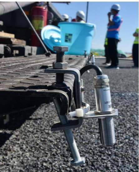
安裝在攤鋪機上的溫度傳感器
