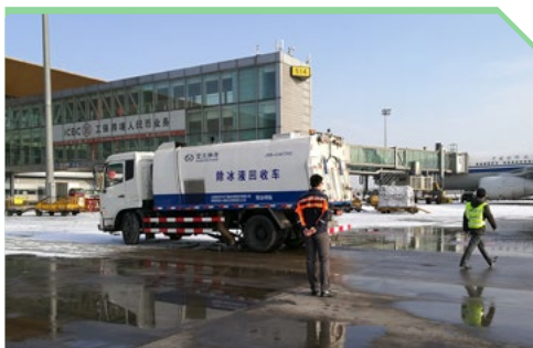
首都機場除冰液回收現場
